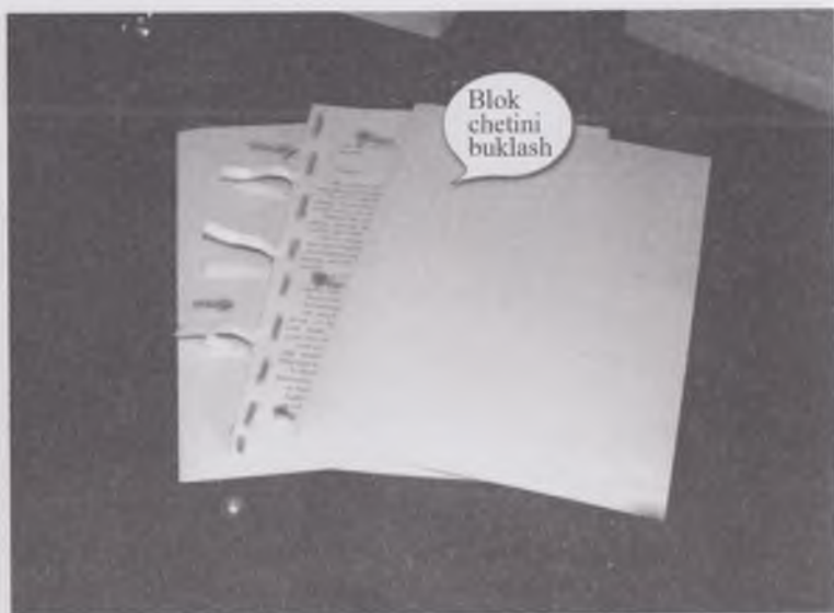
84-rasm. Kitob blokini forzasga birlashtirishga tayyor holati
